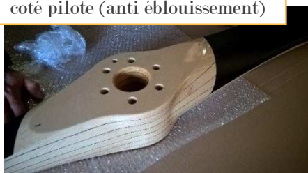
Le bord d'attaque en laiton avec la peinture noire de protection coté pilote (anti éblouissement)
