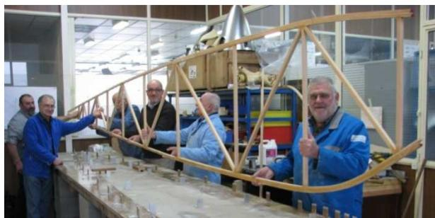
**Nous fabriquons trois gabarits car il nous faut former 52 pièces.(26 intrados, 26 extrados). Mise en place des éléments pour réalisation de l'autre flan de fuselage. Visite du local mis à notre disposition par la CCI. Dans un premier temps nous allons monter les outillages pour assemblage des ailes. Vu le froid et l'humidité nous réservons la suite pour les beaux jours. Collage du flan de fuselage.**
