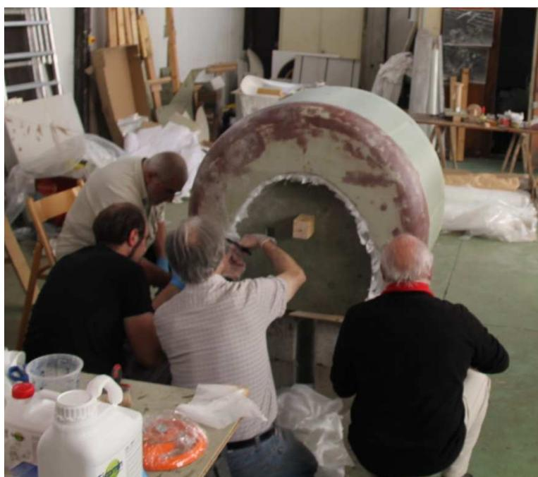
Fabrication du capot AV de fuselage 3 couches de tissus dont un à 45° Démoulage parfait, fabrication d'un outillage en creux pour permettre la mise en place des renforcements à l'intérieur, on le présente sur le fuselage pour détourage extérieur et traçage des passages de la cabane. Réalisation des équerres de fixation du capot AV, et montage sur le fuselage. Nous devons recharger la partie R=80 du capot moteur, ragrément pour une parfaite finition.
