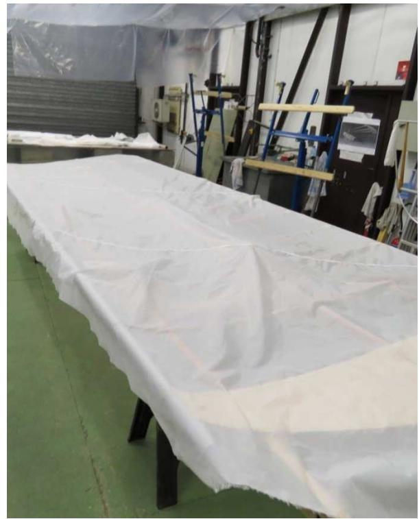
*Nettoyage de la partie intérieure AV du fuselage, ponçage enlever les traces de colle et autres. Occluter les parties entoilées Peindre l'ensemble même la partie déjà peinte. Sur les deux ailes et le plan fixe dernière couche d'enduit avant pose de l'anti UV (fait à l'extérieur).*
